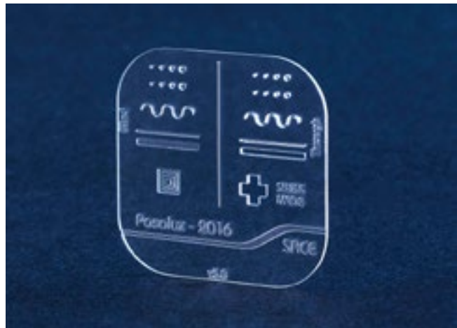
Sample board with available SACE processes / Planche d'échantillons avec tous les procédés SACE disponibles
